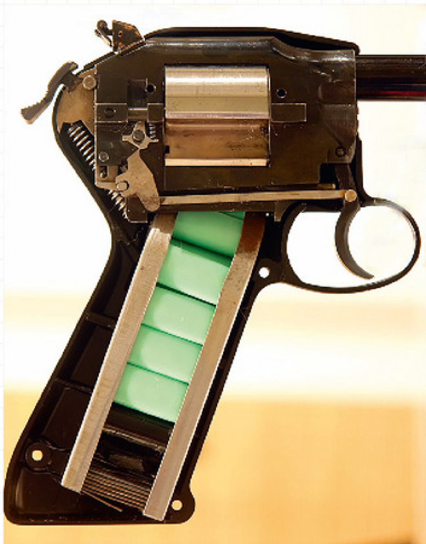
▲ Оружие Дардика не имело надежности револьверов с точки зрения подачи, так как его барабан был завязан на питание из магазина
